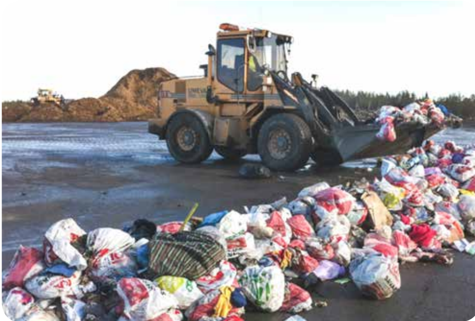
Figur 1 Hjullastare lägger ut ett lass (ett moderprov) i en limpa varifrån fem delprov därefter tas för plockanalys
